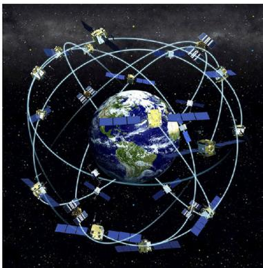
La precisione del sistema GPS si basa sulla misura del tempo che la “luce” (le onde elettromagnetiche) impiega per coprire la distanza tra il punto sulla Terra ed i satelliti.
